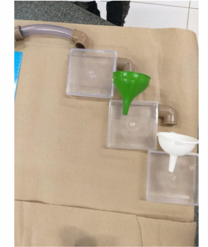
Foto 6 – Detalhe das caixas de cultivo de microalgas. Fonte: Autor
