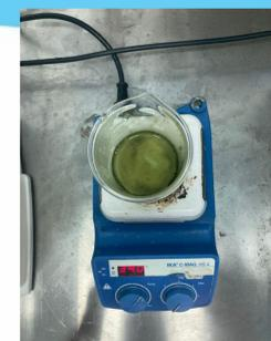
Foto 5 – Produção de bioplástico com microalgas. Fonte: Autor
