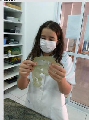
Foto 8 – Bioplástico produzido de microalgas pelo método de casting com acetona. Fonte: Autor
