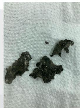
Foto 6 – Bioplástico produzido de microalgas com acetona. Fonte: Autor
