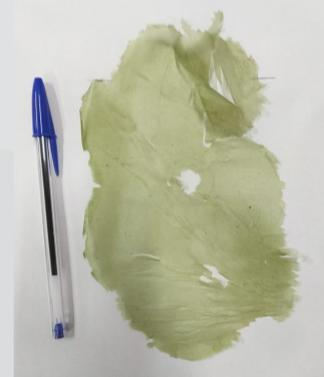
Foto 9 – Bioplástico produzido de microalgas pelo método de casting com acetona. Fonte: Autor
